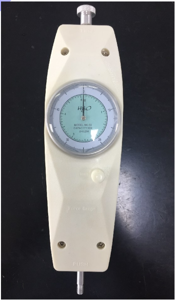
图 2 弹簧秤附着力仪自带的测力计
