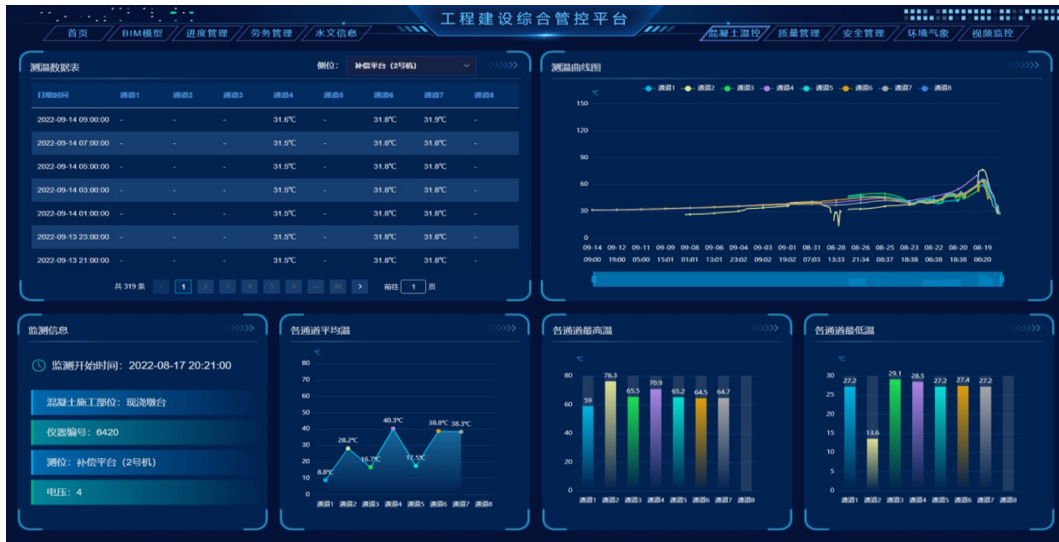
图 5 大体积混凝土温控数据大屏
