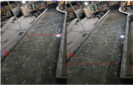
图 4 泄水过程下引航道流态
