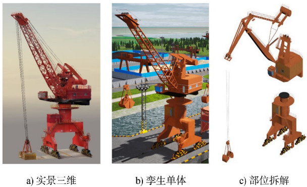
图 4 门机孪生体及驱动部位构建流程
