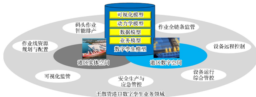
图1 数字孪生在港口干散货作业的应用领域
