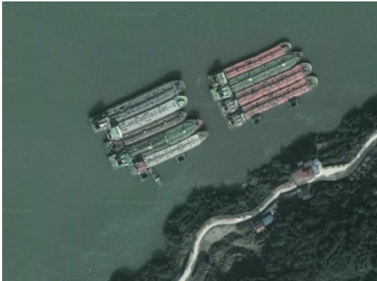
图 3 利用系靠船墩顺岸系泊
