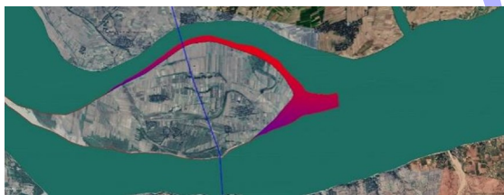
图 14 预测的江心岛冲蚀退化平衡状态
