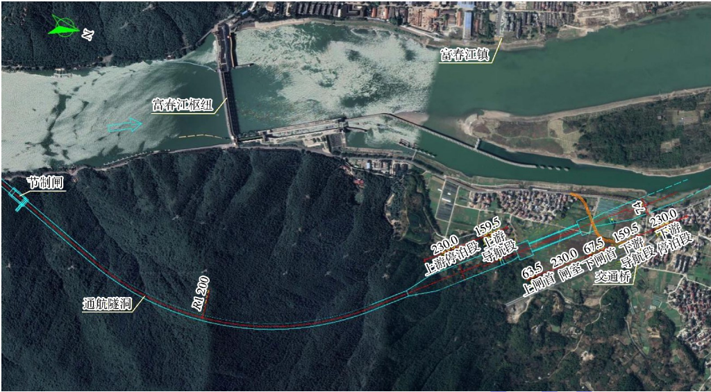
图 4 船闸+曲线隧洞方案平面布置 (单位: m)
