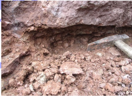
图 2 开挖坡面揭露的岩屑夹泥型软弱结构面
