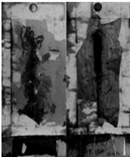
a) 环氧云母底漆(80 μm, 2 160 h)
