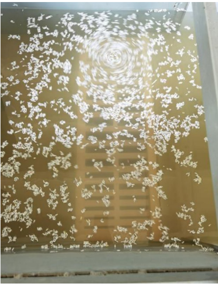
图 5 充水阀门双边开启时进水口附近流态
