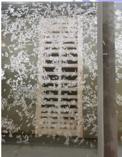
图 7 推荐布置充水阀门双边开启时进水口水流状态
