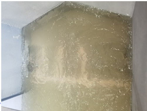
图 8 泄水阀门双边开启时出水口附近流态
