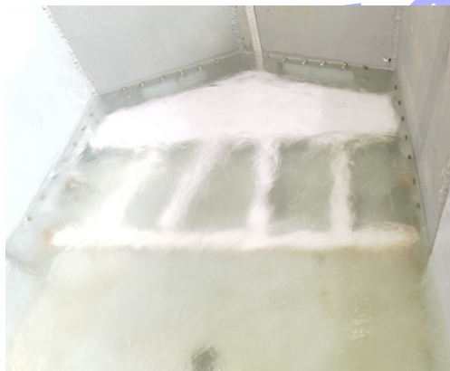
图10 推荐布置泄水阀门双边开启时出水口附近流态
