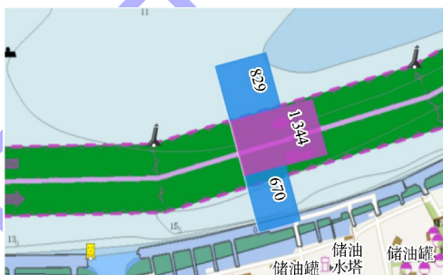
图 9 福姜沙南水道门线各断面船舶数量直方图 (单位: 艘)
