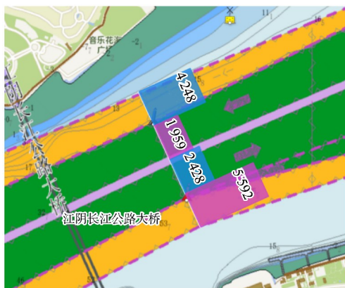
a) 通过航道门线各断面的船舶数量直方图(单位:艘)
