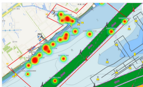
图 11 安宁港前区域的碰撞危险度热力图
