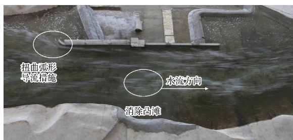
图 7 Q=2.35 万 \text{m}^3/\text{s} , 优化方案通航水流流态
