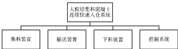
图 1 桁架式大粒径集料混凝土连续快速入仓系统构造
