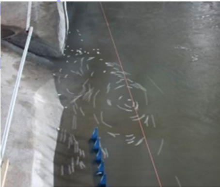
图 7 Q=1.50 万 \text{m}^3/\text{s} 时方案 2 上引航道口门区流态
