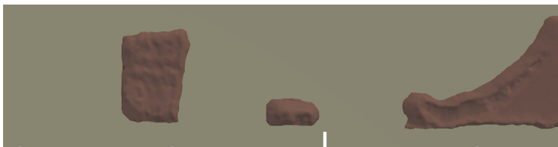
图7 车辆轨迹残留移除后的料堆模型
