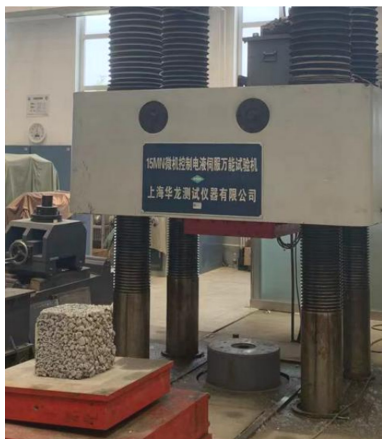
图 3 碎石集料拌合物 28 d 龄期的试块抗压强度试验
