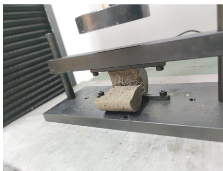
图4 固化土劈裂破坏面
