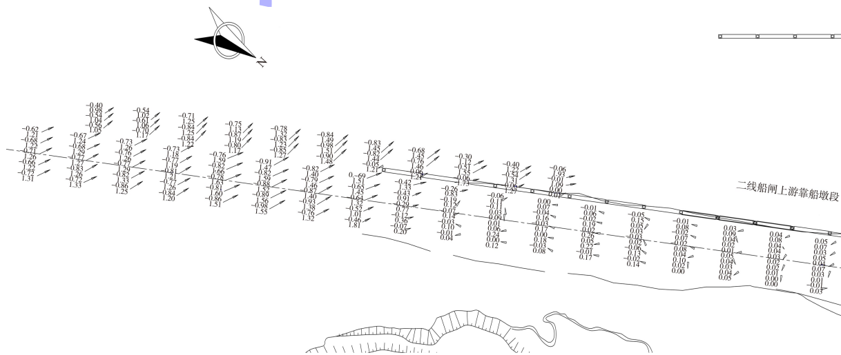
图5 优化方案在 C-3 工况下一、二线船闸口门区流速 (单位: m/s)
