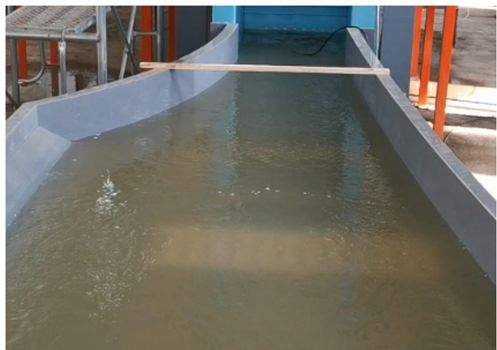
图4 下游引航道水流流态
