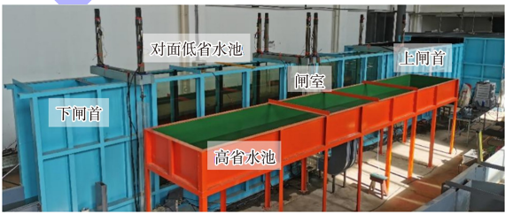
图 2 省水船闸整体物理模型
