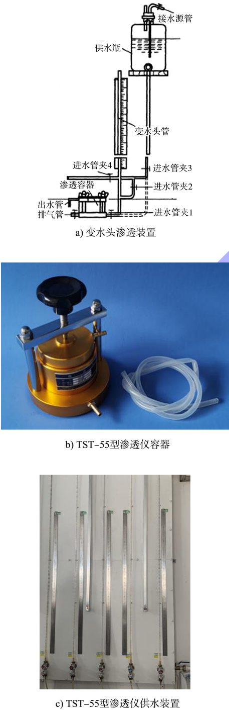
图 1 变水头渗透装置及 TST-55 型渗透仪
