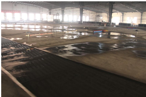
图 2 整体波浪模型试验水池
