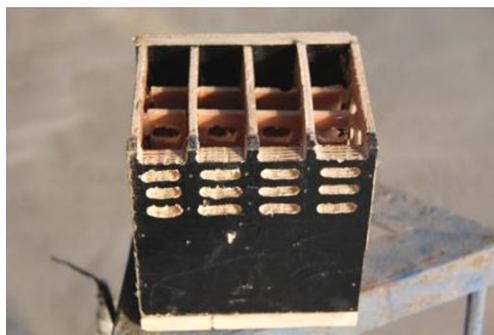
图 3 开孔沉箱模型实物
