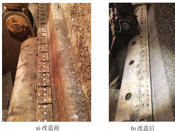
图11 固定方式改造前后的情况
