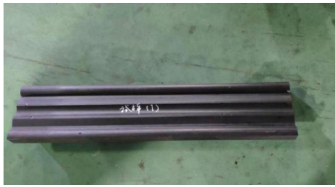
图 2 厂内制作的充压水封接头试样
