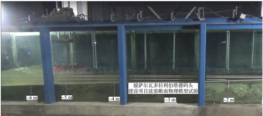
图 6 波浪断面模型试验
