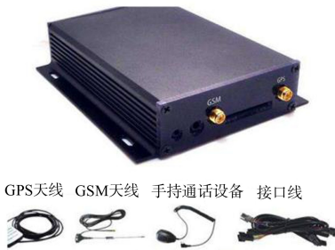
图 9 车辆监控系统主要设备
