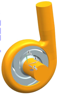
图 1 900 泥泵 CFD 三维模型
