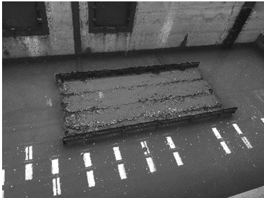
图 6 不同喷嘴直径下的射流冲坑
