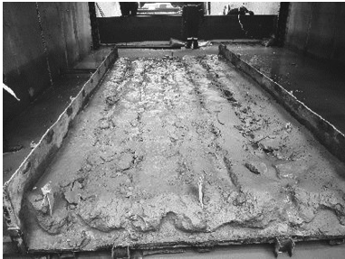
图 2 不同移动速度下的射流冲坑
