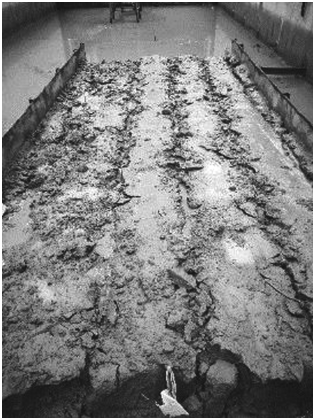
图 4 不同靶距下的射流冲坑
