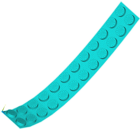
图 2 宽 1 m 软体排有限元模型
