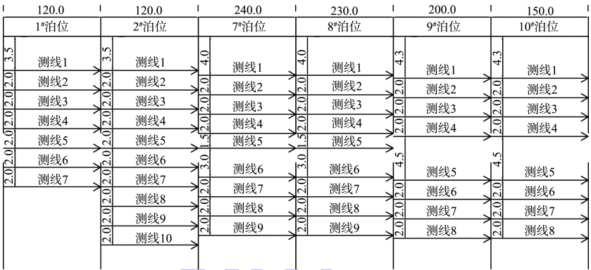
图 6 探地雷达测线布置 (单位: m)
