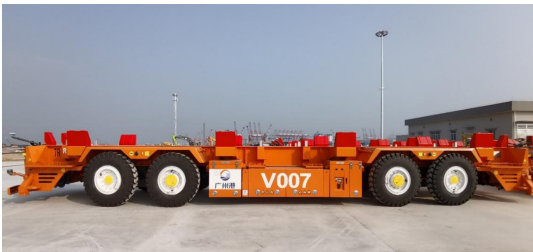
图 3 采用多传感器融合导航定位的 IGV
