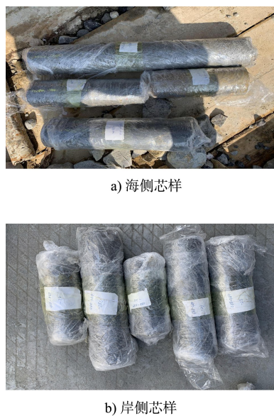
图 8 高压旋喷桩钻孔芯样
