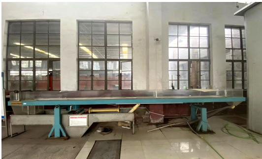
图 1 高精度河流动力学试验水槽装置
