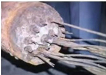
c) 拉索锈蚀、断裂
