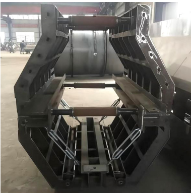
图 3 导轨-模板体系实物
