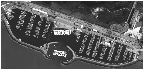
图 2 罗马游艇码头长周期波消波措施
