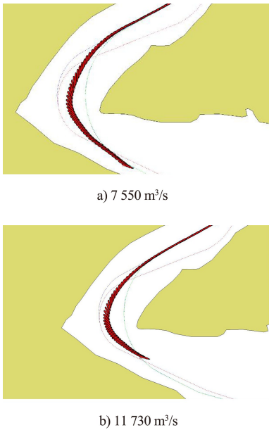
图 4 不同流量下急弯段下行船舶航行轨迹
