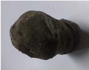
b) 利用灌浆法形成冲刷坑轮廓胚体后形状
