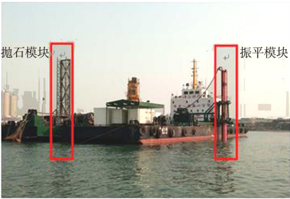
图 3 振夯整平一体船结构
