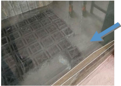
图 9 陶粒混凝土结构护坡(边坡比 1:24)失稳
