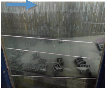
b) 破波带位于护坡中部(陶粒混凝土)
