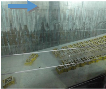
c) 破波带位于护坡底部(素混凝土)
