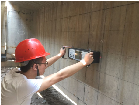
图 3 超声横波三维成像现场试验检测
