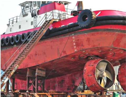
图 7 某全回转拖轮底部
