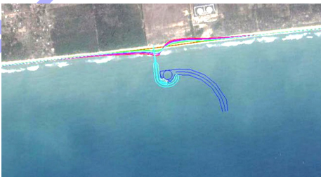
图 10 工程区岸线演变模型计算结果
