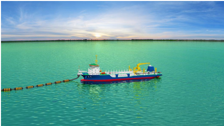
图 4 船舶后移至管口并接管头
