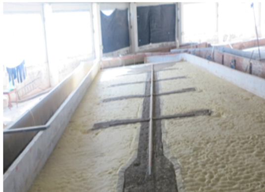
a) 护滩丁坝局部冲刷试验照片
