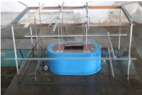
图 4 沉井浮体模型试验
