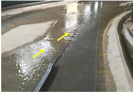
b) 流量1 062 m 3 /s 注: 箭头表示主流流向。 图 4 原方案下游引航道口门区流态
