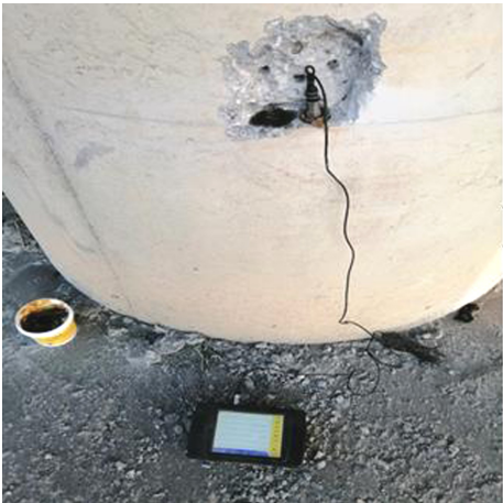
图 3 低应变检测法
