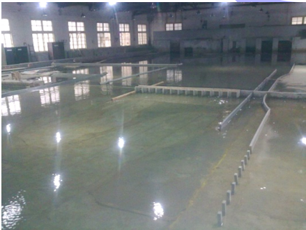
图 3 通航水流条件模型试验
