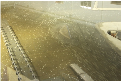
图 8 实施分流泄洪通道措施后流态
