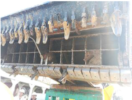
图 1 耙吸式挖泥船耙头格栅阻塞
