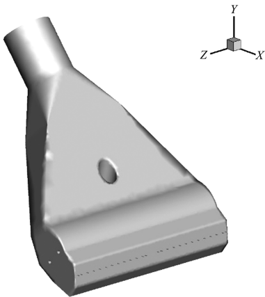
图 2 耙头内流场计算区域模型
